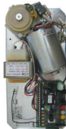
Ajuste manual de los finales de carrera.
